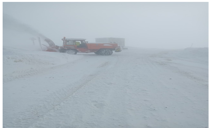
Autospeciale 4x4 pentru dezzăpezire, dotate cu lamă și sărăriță
